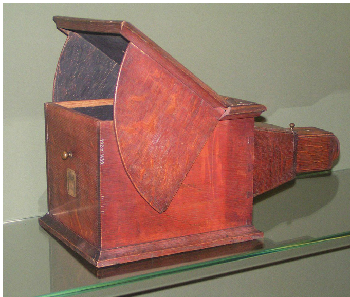
Camera obscura, wie sie im 18. Jahrhundert als Skizzier-Instrument verwendet wurde. Science Museum, London.
